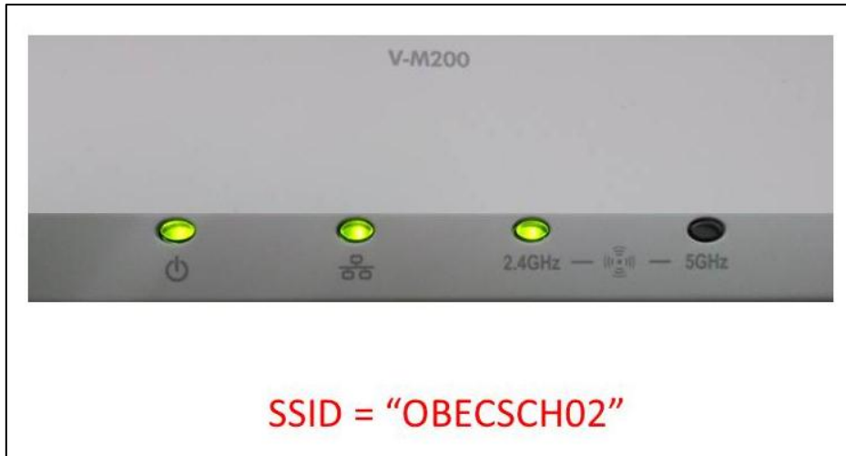
ภาพด้านบน แสดงไฟสถานะ LED ของ Access Point ที่ทำงานปกติ
